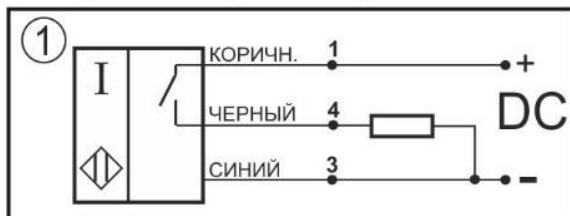
Схема соединения Нормально-разомкнутый контакт
