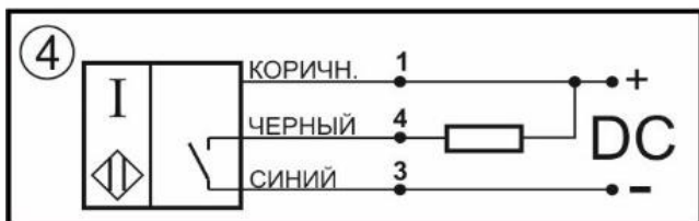
Схема соединения Нормально-разомкнутый контакт
