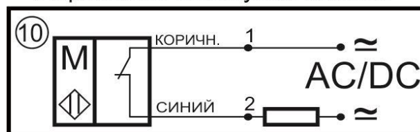
Схема подключения Нормально-замкнутый контакт
